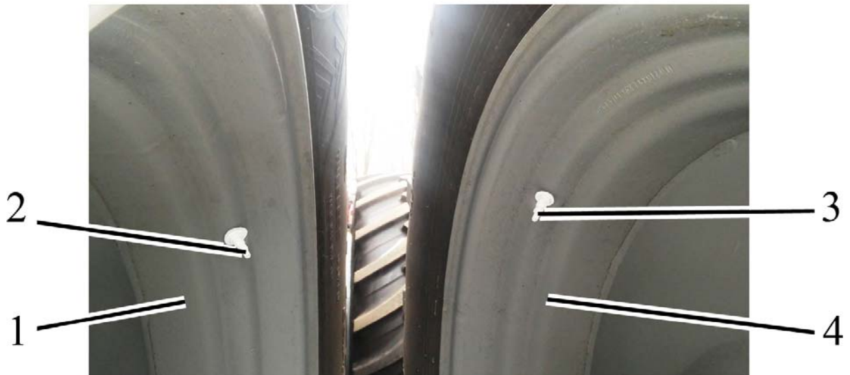
Рисунок 4.2.5.1 – Расположение вентилях пары сдвоенных колес
