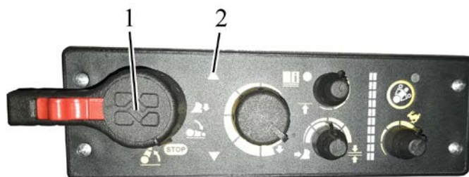
1 – рукоятка управления задним навесным устройством; 2 – сигнализатор подъема ЗНУ. Рисунок 3.16.10а – Пульт управления ЗНУ
