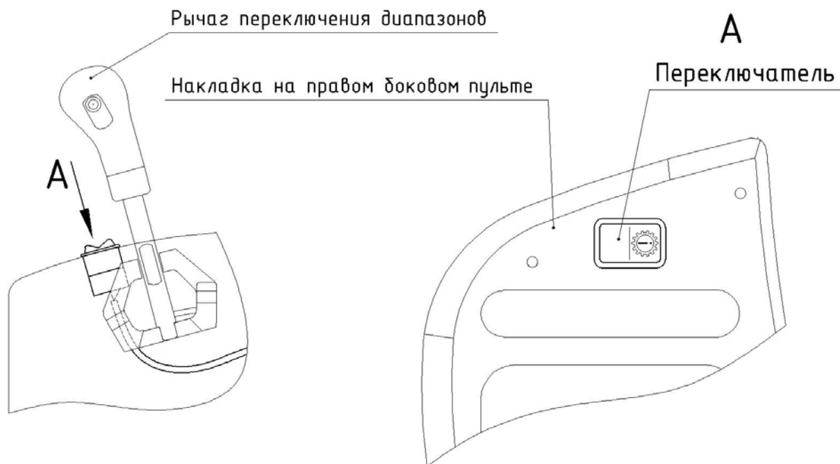
Рисунок 4.5.2 - Переключатель аварийного управления трансмиссией при перегреве двигателя
